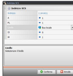
Per il comando **Serratura** viene richiesto di scegliere l'Indirizzo videocitofonico ovvero l'indirizzo del posto esterno associato all'impianto (se il dispositivo è cablato sulla Videocitofonia); se il dispositivo è cablato sul BUS SCS al comando **Serratura** vanno inseriti i valori A e PL.
