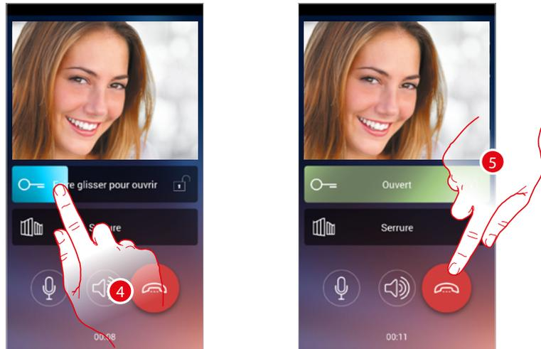
4. Il est en outre possible d'ouvrir la serrure du Poste externe dont provient l'appel, en glissant l'interrupteur ; quand elle devient verte, la serrure est activée ; si elle reste bleu ciel, cela indique que la commande n'a pas été correctement effectuée.
