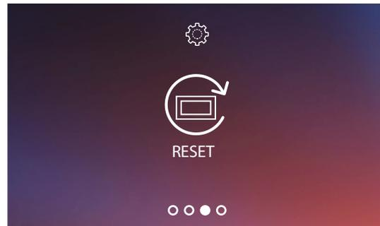
1. Den Joystick drücken, um das Gerät zurückzusetzen.
