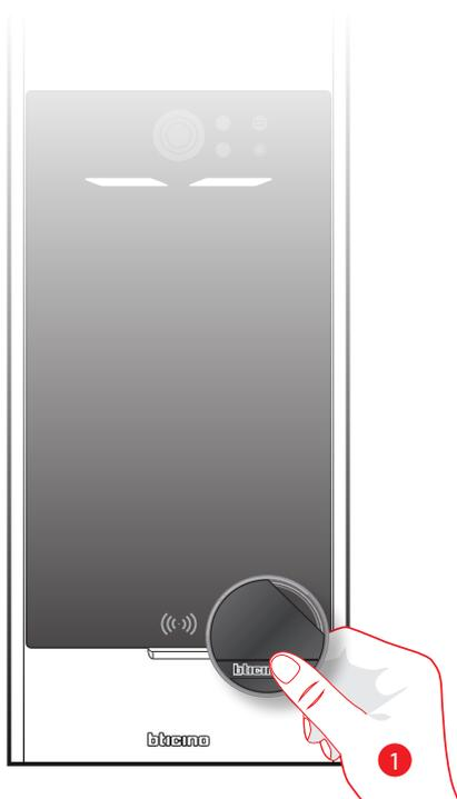
1. Posicione el badge delante de la placa exterior a la altura del lector RFID
