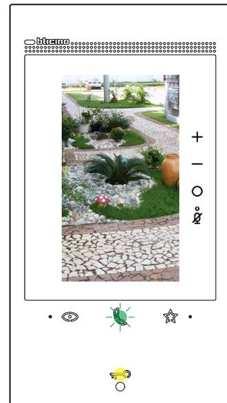
2. Toque para activar la placa exterior o la videocámara deseada
