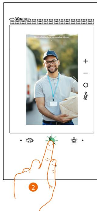
2. El led comunicación parpadea, toque la tecla comunicación para activar la comunicación audio
