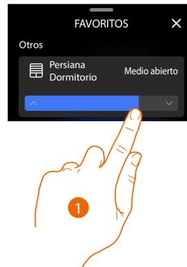
1. Toque y deslice hacia la derecha/izquierda para abrir/cerrar la persiana hasta el punto elegido; el comando se ejecuta al final de la presión. El objeto muestra el estado de apertura de la persiana
