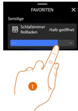
1. Berühren und nach rechts/links verschieben, um den Rollladen so weit wie gewünscht zu öffnen/schließen.
