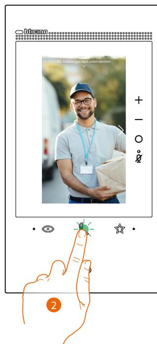
2. Die Kommunikationsled blinkt. Berühren Sie die Kommunikationstaste, um die Audioverbindung herzustellen
