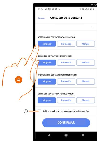
4. Toque para no efectuar una acción de la instalación de calefacción o refrigeración durante la apertura/cierre del contacto ventana.
