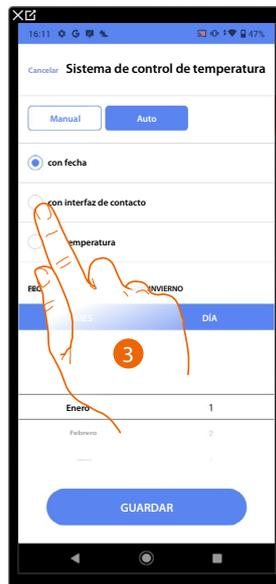
3. Toque para configurar el cambio de estación automático mediante la Interfaz de Contacto
