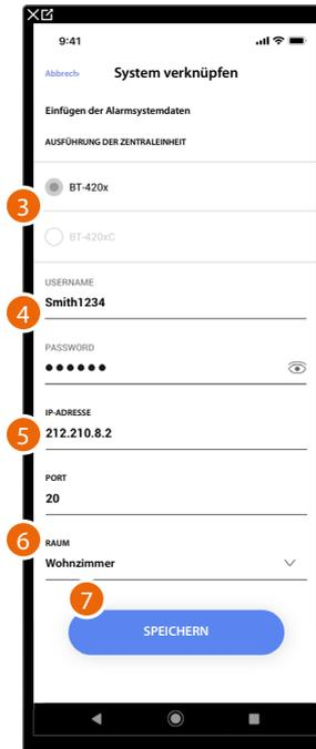
3. Wählen Sie die Art der Zentrale, die in der Anlage installiert ist
