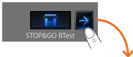
Al ingresar a la página específica del dispositivo STOP&GO BTest, es posible activar o desactivar la función Autotest pulsando el icono **T**. Si se activa, mediante los iconos **-** y **+** es posible establecer la frecuencia (número de días entre una prueba y la siguiente) de autotest.
