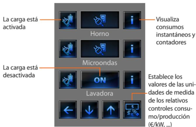
Si la centralita detecta una sobrecarga en la instalación, se desactivará la carga con menor prioridad (configurada antes con TiDisplayColorIP), y se visualiza el icono
