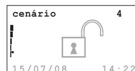
Instalação ligada, a placa SIM está a faltar ou está bloqueada (veja Manual de instalação)
