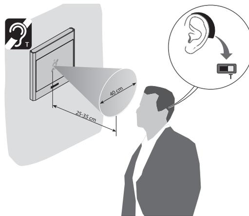
**NOTE :** la présence de métal et de bruit de fond généré par des appareillages électriques/électroniques (ex. ordinateurs) peuvent compromettre la qualité et les performances du dispositif d'accouplement.
