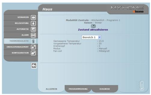
Die Meldung des auf "Manuell" geschalteten Zustands der Zone wird in den Webseiten und an der Zentrale mit dem Symbol 🕙 angezeigt.
