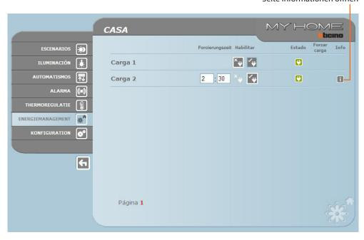
Wenn die Zentrale eine Stromüberlastung erfasst, wird die Last mit der geringsten Priorität abgeschaltet und es erscheint das Icon , das angeklickt werden muss, um die Last wieder einzuschalten.
