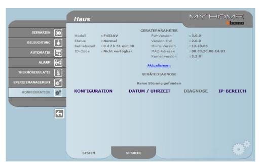
Durch Anklicken von "IP-BEREICH" erscheint die Seite, auf der der IP - Adressenbereich eingegeben wird, innerhalb dessen die Verbindung ohne Passwort erfolgen kann.
