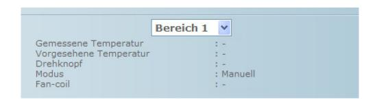
Wenn aber die Bus-Verbindung unterbrochen, der Strom ausgefallen ist oder der Web Server nicht antwortet, werden bei allen Einträgen nur Bindestriche "-" angezeigt:
