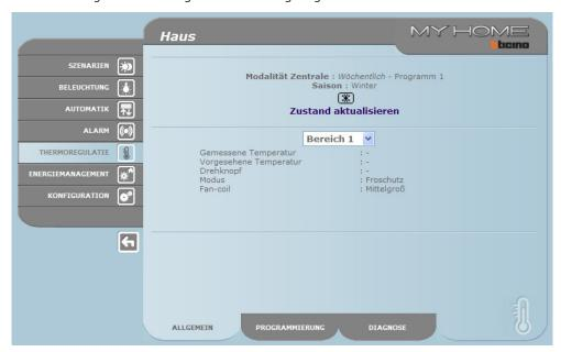
Die Meldung des auf "Frostschutz" geschalteten Zustands der Zone wird in den Webseiten und an der Zentrale mit dem Symbol 🕱 angezeigt.
