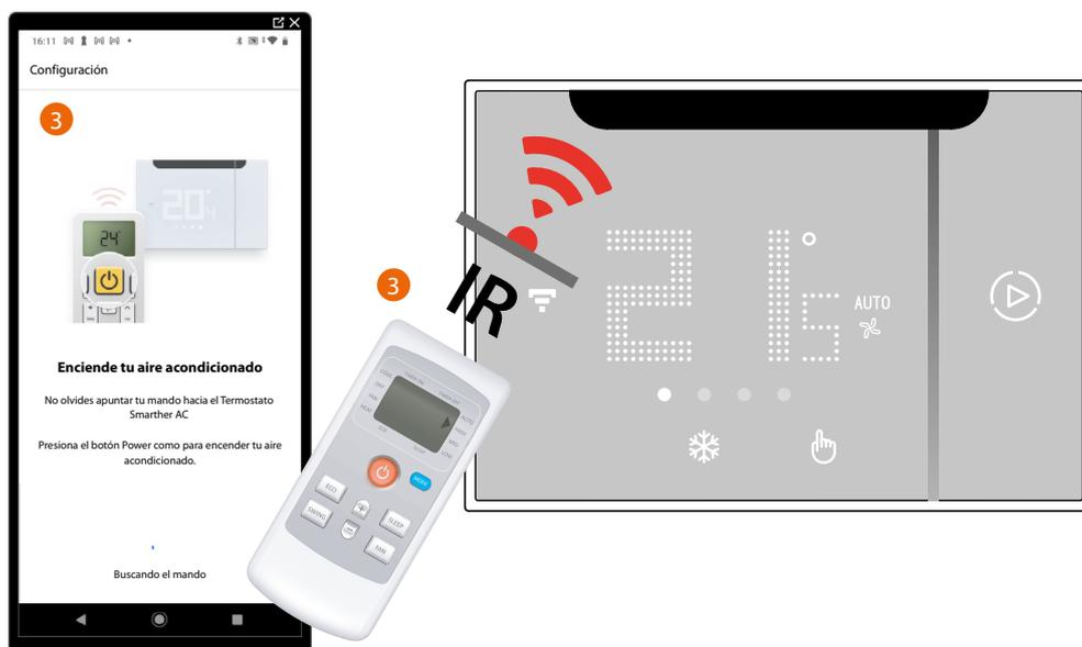
3. Posicione el mando a distancia del aire acondicionado Split IR delante del Smarther AC y pulse el botón de encendido del climatizador.
