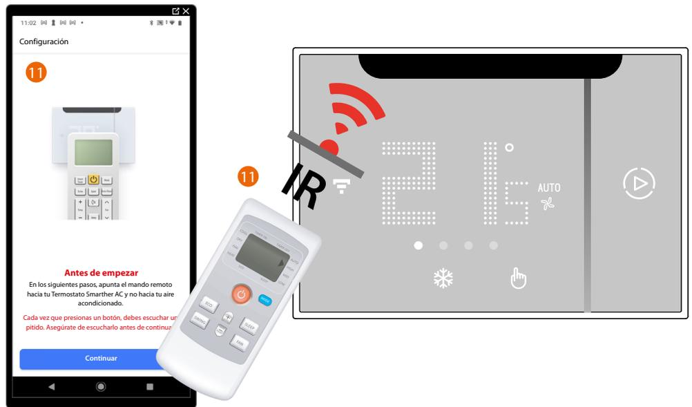
11. Posicione el mando a distancia del aire acondicionado Split IR delante del Smarther AC.
