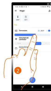
2. En el Smarther AC toque los botones
