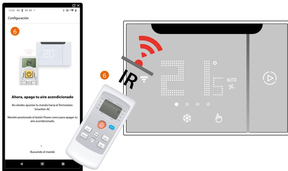
6. Posicione el mando a distancia del aire acondicionado Split IR delante del Smarter AC y pulse el botón de apagado del climatizador.
