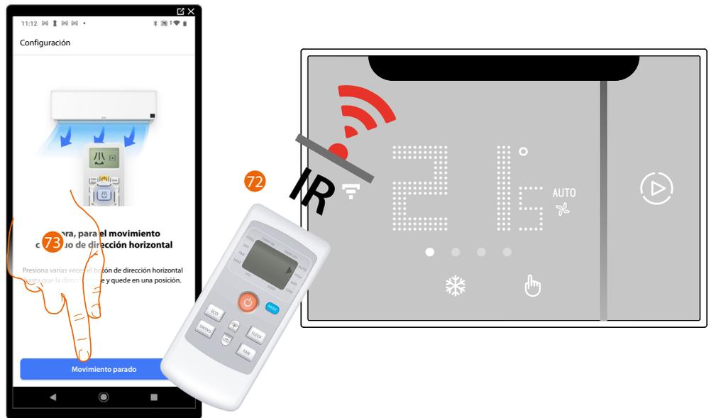
72. Pulse varias veces el botón de oscilación horizontal hasta que el movimiento de las aletas se interrumpa y estas permanezcan en una posición fija.
