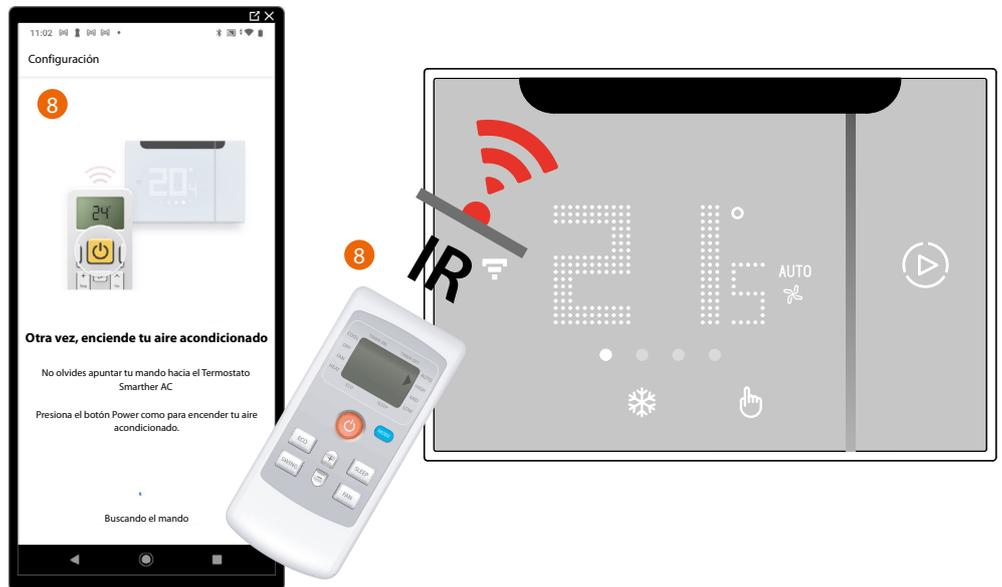
8. Posicione el mando a distancia del aire acondicionado Split IR delante del Smarther AC y pulse el botón de encendido del climatizador.
