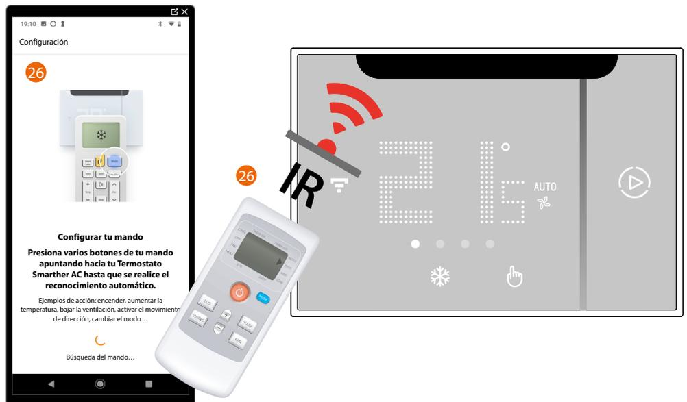
26. Posicione el mando a distancia del aire acondicionado Split IR delante del Smarther AC y pulse varios botones del mando a distancia (por ej.: encendido, subir temperatura, etc.) hasta que el mando a distancia es reconocido.
