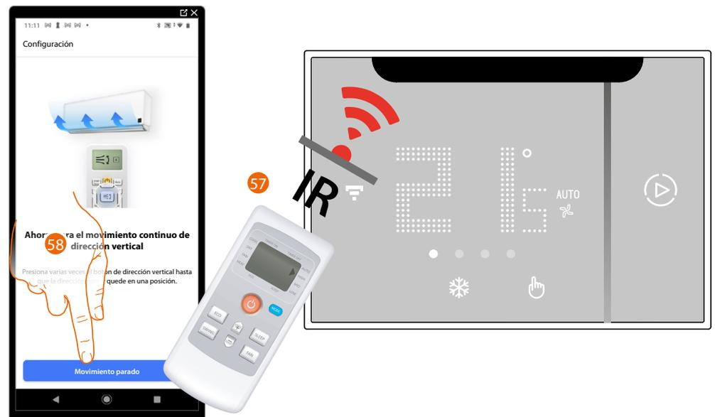
57. Pulse varias veces el botón de oscilación vertical hasta que el movimiento de las aletas se interrumpa y estas permanezcan en una posición fija.
