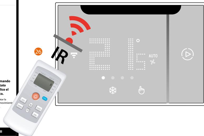
26. Posicione el mando a distancia del aire acondicionado Split IR delante del Smarther AC y pulse varios botones del mando a distancia (por ej.: encendido, subir temperatura, etc.) hasta que el mando a distancia es reconocido.
