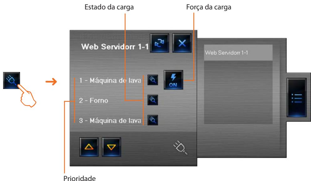
Se houver sobrecarga, pode acontecer que um destes dispositivos fique desactivado, se o botão que está à direita da carga desactivada for pressionado é possível forçar o estado para activá-lo novamente.
