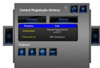
Na janela aparece a então a nova modalidade de funcionamento (Manual de Aquecimento)
