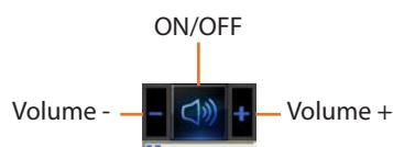
O objecto para o amplificador está dividido em 4 partes, a parte central visualiza o estado liga/desliga do amplificador. Os botões à esquerda e à direita, permitem regular o volume e logo o nível do volume aparecerá no visor inferior.
