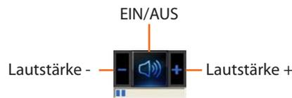
Das Objekt Verstärker ist in 4 Bereiche gegliedert, in der Mitte wird der Zustand angezeigt und der Verstärker ein- und ausgeschaltet. Mit den Tasten links und rechts wird die Lautstärke reguliert, die Lautstärke selbst wird im darunter liegenden Feld angezeigt.
