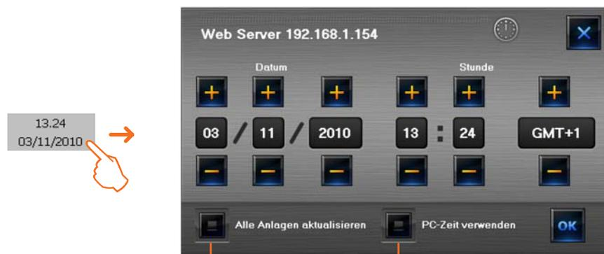
Alle angeschlossenen Anlagen auf die eingestellte Uhrzeit und das Datum aktualisieren
