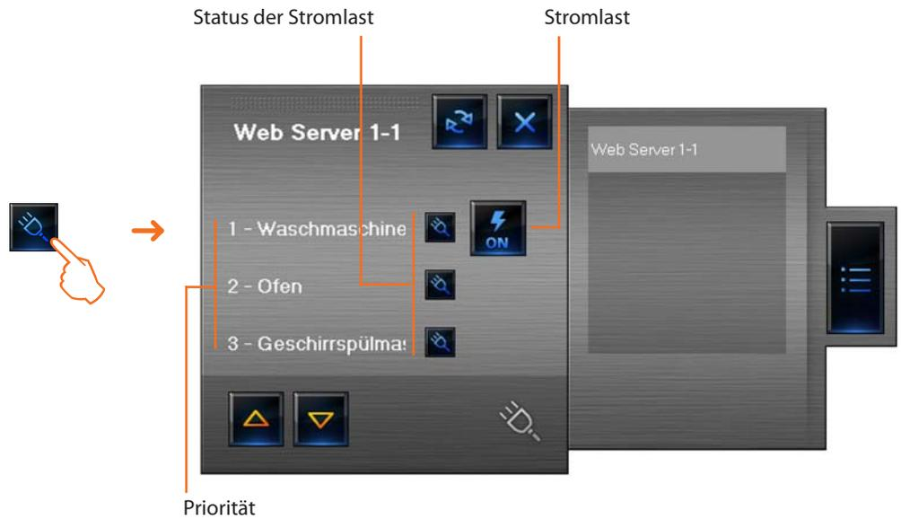
Bei Überbelastung wird eines der Geräte ggf. angeschaltet. Durch Anklicken der Taste, die rechts neben der abgeschalteten Stromlast erscheint, kann der Status forciert und das Gerät wieder eingeschaltet werden.
